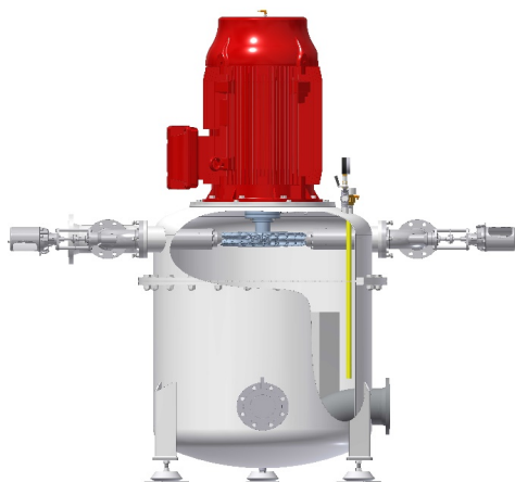
Das Prinzip der Pelton-Gegendruckturbine. Häny AG
