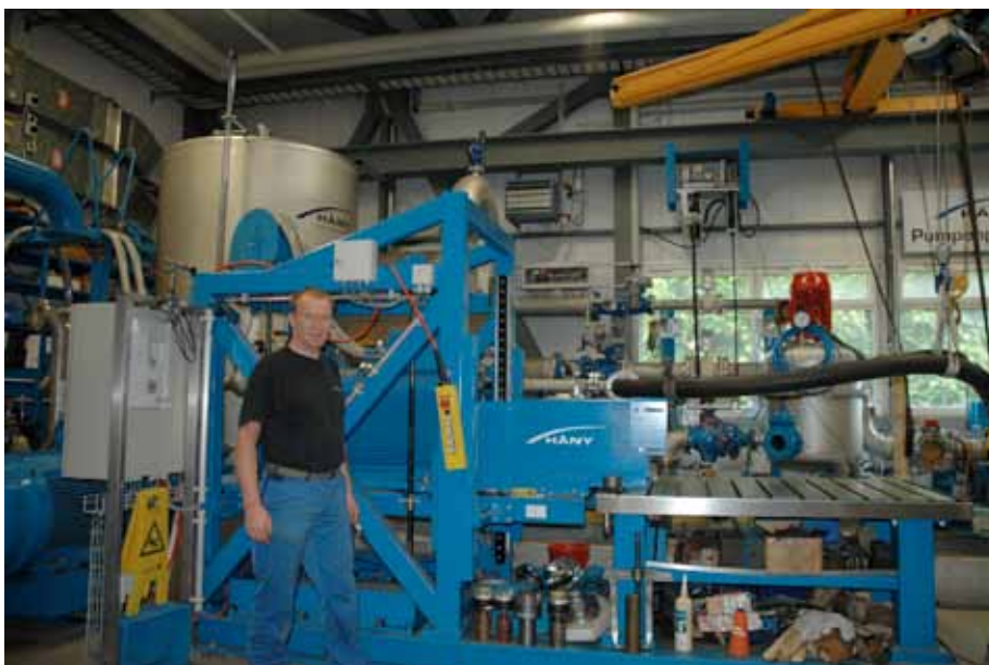
Die Häny AG in Jona/SG verfügt über einen Prüfstand, wo die Leistung von Motoren und Pumpen vor der Installation getestet werden kann. Foto: Pieter Poldervaart
