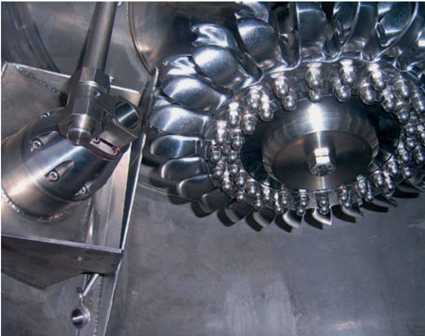
Bild 6: Die komplett in Chrom-Nickelstahl gefertigte Turbinenteile
