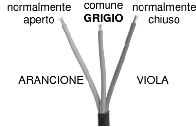
Figura 5 – Configurazione dei contatti, cavo di segnalazione
