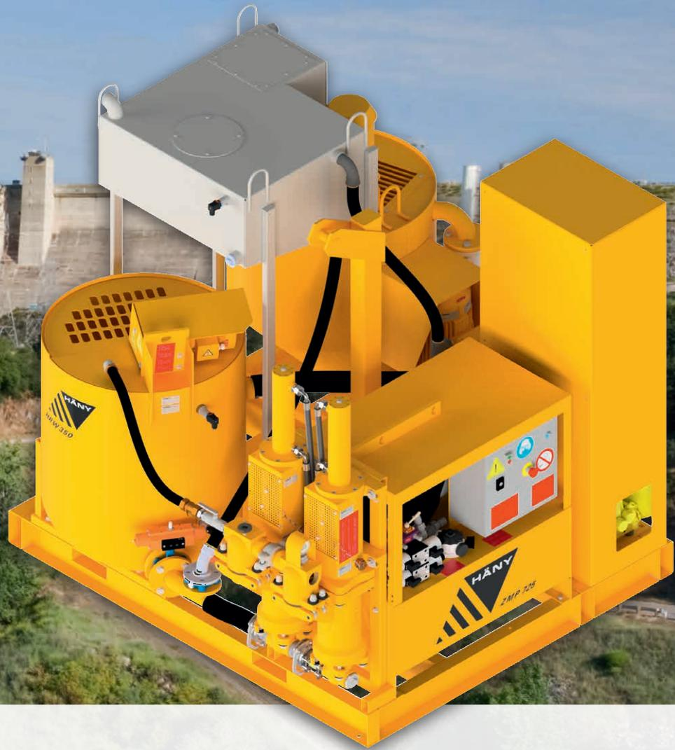
Die Kombination der bewährten Häny-Standardkomponenten Mischer, Rührwerk und Injektionspumpe resultiert in einer kompakten Injektionsanlage. In der automatischen Ausführung bringt die Anlage neben enormen Ersparnissen an Personalkosten auch hohe Produktionsleistung, Qualitätsüberwachung und angenehmere Arbeitsbedingungen.
