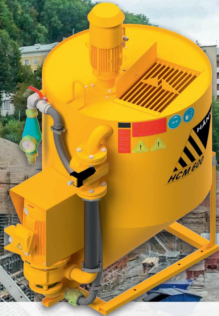
Der Turbomischer (Kolloidalmischer) eignet sich speziell zur Herstellung von Suspensionen bestehend aus Wasser, Zement, Feinstbindemittel, Bentonit, Sand und weiteren Zusätzen. Ein solider Mischbehälter kombiniert mit hochverschleissfesten Materialien in der Mischpumpe garantieren eine lange Lebensdauer und störungsfreien Betrieb.
