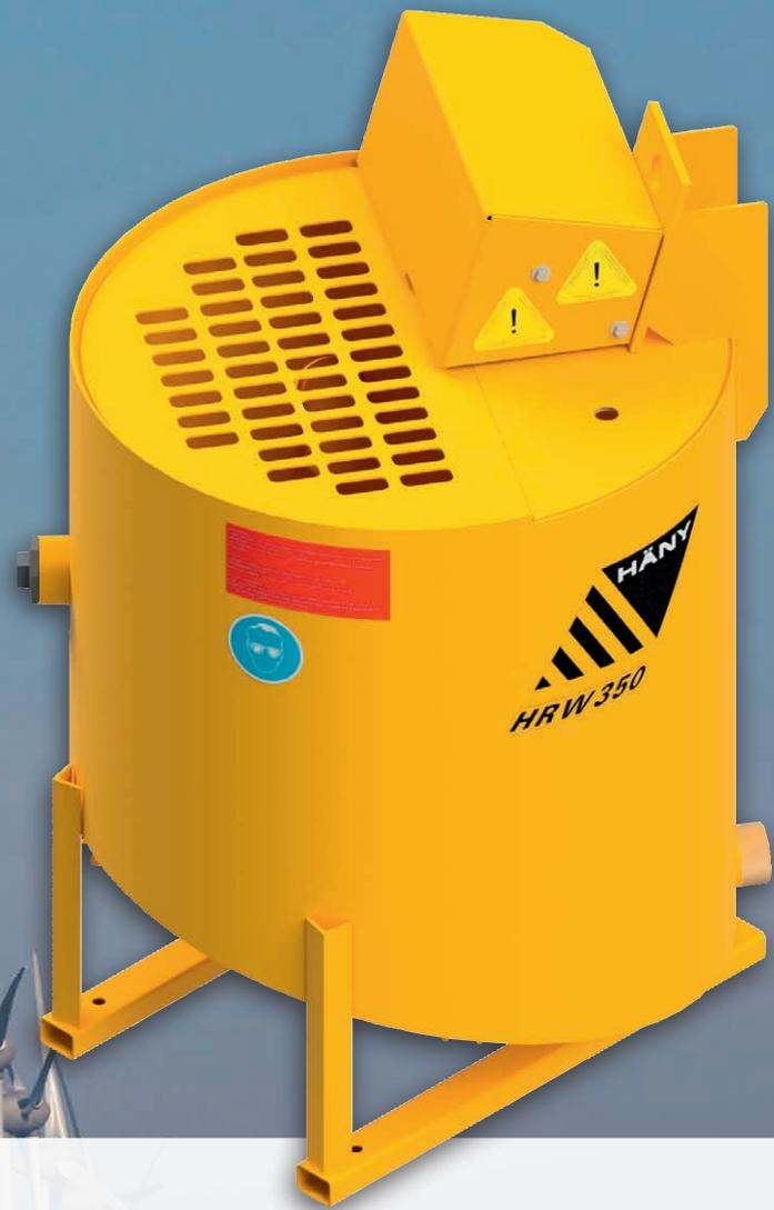
Rührwerke stellen den kontinuierlichen Betrieb sicher, indem sie die angemischte Suspension aufnehmen, homogenisieren und allfällig vorhandene Luftblasen durch ein langsam drehendes Paddel entfernen. Optionale Füllstandssensoren ermöglichen den vollautomatischen Betrieb.
