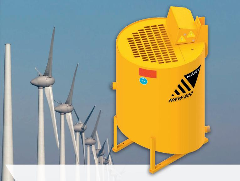
Rührwerke stellen den kontinuierlichen Betrieb sicher, indem sie die angemischte Suspension aufnehmen, homogenisieren und allfällig vorhandene Luftblasen durch ein langsam drehendes Paddel entfernen. Optionale Füllstandsensoren ermöglichen den vollautomatischen Betrieb.
