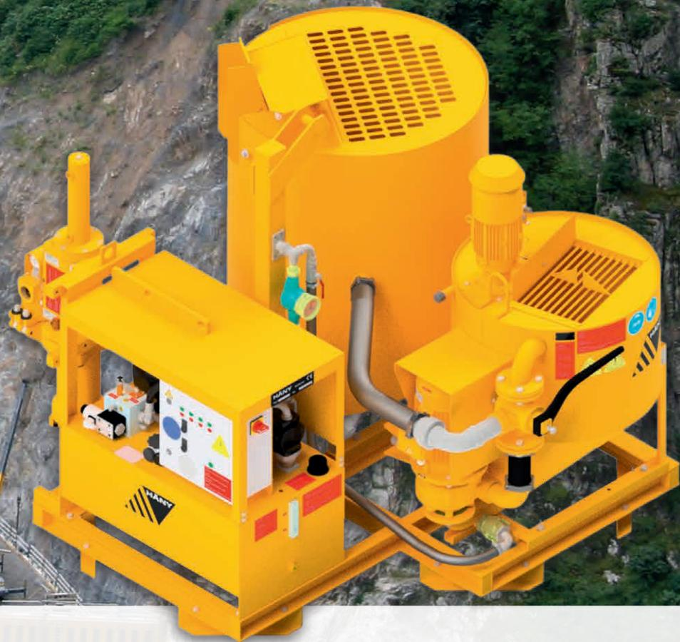
Die Kombination der bewährten Häny-Standardkomponenten Mischer, Rührwerk und Injektionspumpe resultiert in einer kompakten Injektionsanlage. Diese eignet sich für die verschiedensten Applikationen im Bereich Anker-, Manschettenrohr und Kontaktinjektionen. Für eine konstant hohe Produktionsleistung und Qualität stehen optional halb- wie vollautomatische Anlagen zur Verfügung.
