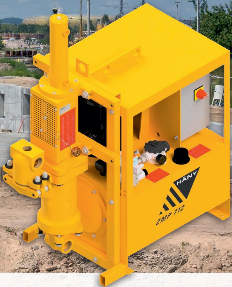
Kompakte und verschleissarme Plungerpumpe für das Verpumpen von Suspensionen mit niedrigem W/Z-Faktor und Fließmörtel mit Sandanteil. Geeignet für alle Injektionsarbeiten sowie für die Förderung von Hinterfüllmörtel beim Tübbing Ausbau von Tunneln.
