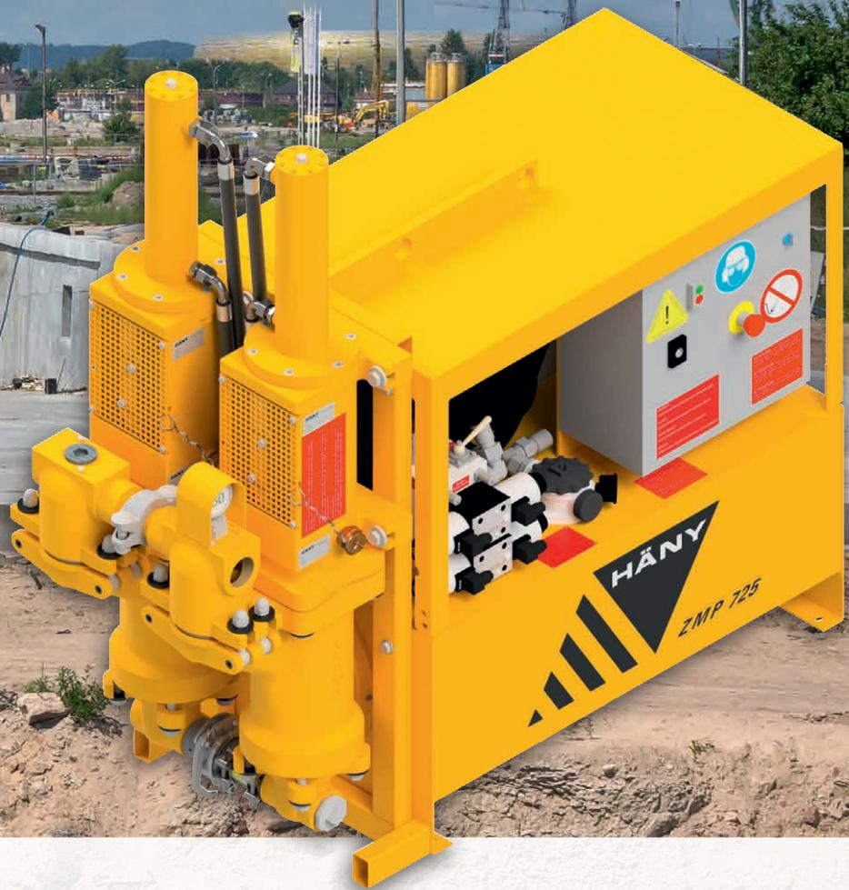
Kompakte und verschleissarme Plungerpumpe für das Verpumpen von Suspensionen mit niedrigem W/Z-Faktor und Fließmörtel mit Sandanteil. Geeignet für alle Injektionsarbeiten sowie für die Förderung von Hinterfüllmörtel beim Tübbing Ausbau von Tunneln.
