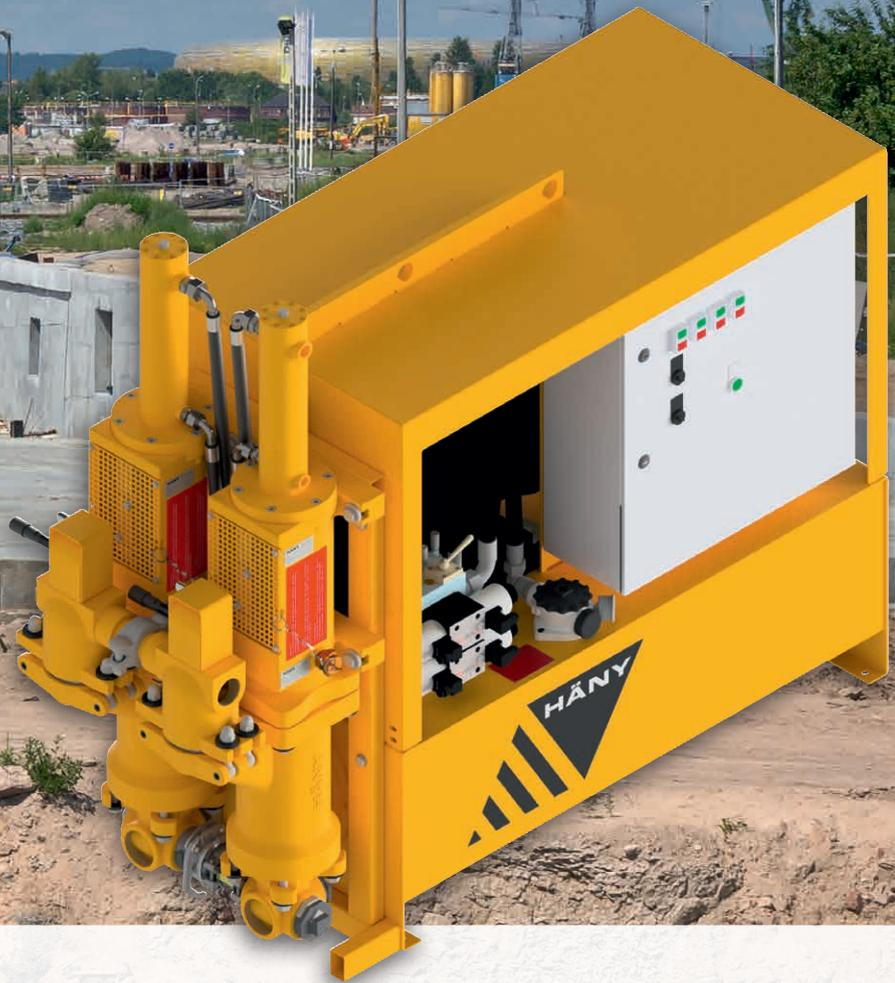
Kompakte und verschleissarme Plungerpumpe für das Verpumpen von Suspensionen mit niedrigem W/Z-Faktor und Fließmörtel mit Sandanteil. Geeignet für alle Injektionsarbeiten sowie für die Förderung von Hinterfüllmörtel beim Tübbing Ausbau von Tunneln.
