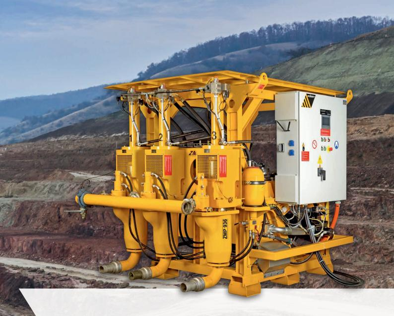
Hochvolumige standalone Triplex-Plungerpumpe für konstante Förderung bei minimaler Pulsation. Das hocheffiziente Hydrauliksystem ist auf einem platzsparenden Rahmen montiert und kann für verschiedene Anwendungen eingesetzt werden.
